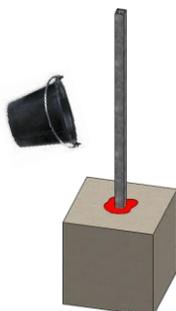
4 – Mettez le fer de niveau avant la prise de béton
