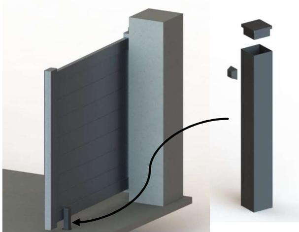
**Etape 2 :** Créez une réservation, scellez le tube avec du scellement chimique ou du mortier
