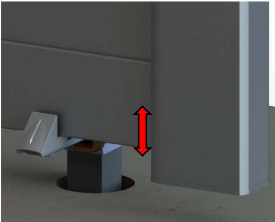
**Etape 5 :** Réglez la profondeur de l'arrêteoir (entre 28 et 86 mm) de manière à bloquer le vantail
