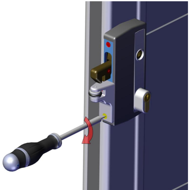
Effectuez le serrage du cylindre à l'aide de la vis inox tête fraisée M5x70
