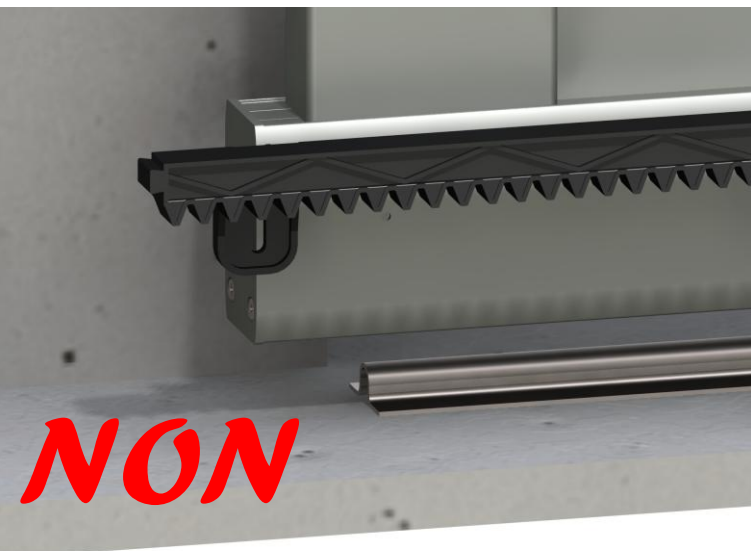
Vérifiez que la fixation de la dernière patte ne soit pas dans le vide. Si c'est le cas répartissez au mieux l'ensemble de la crémaillère
