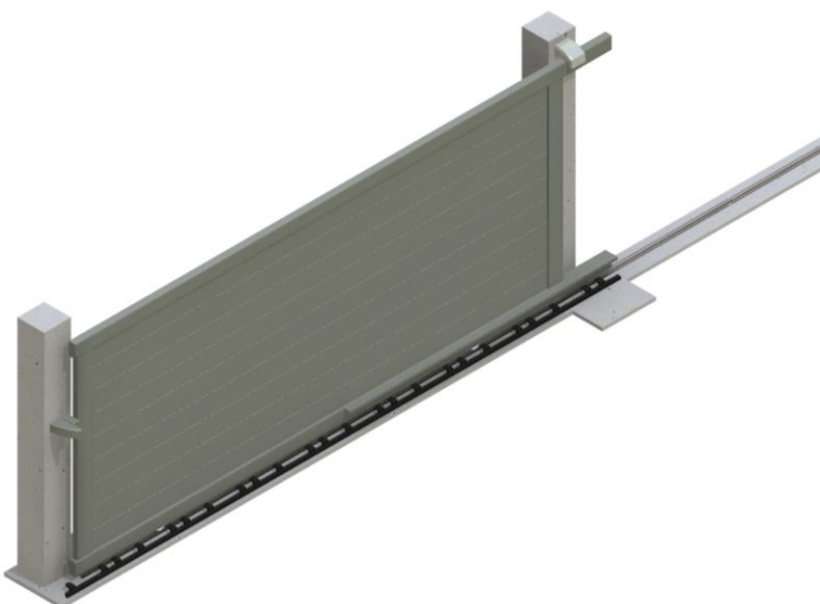
Assemblez les éléments de la crémaillère et la posez au sol
